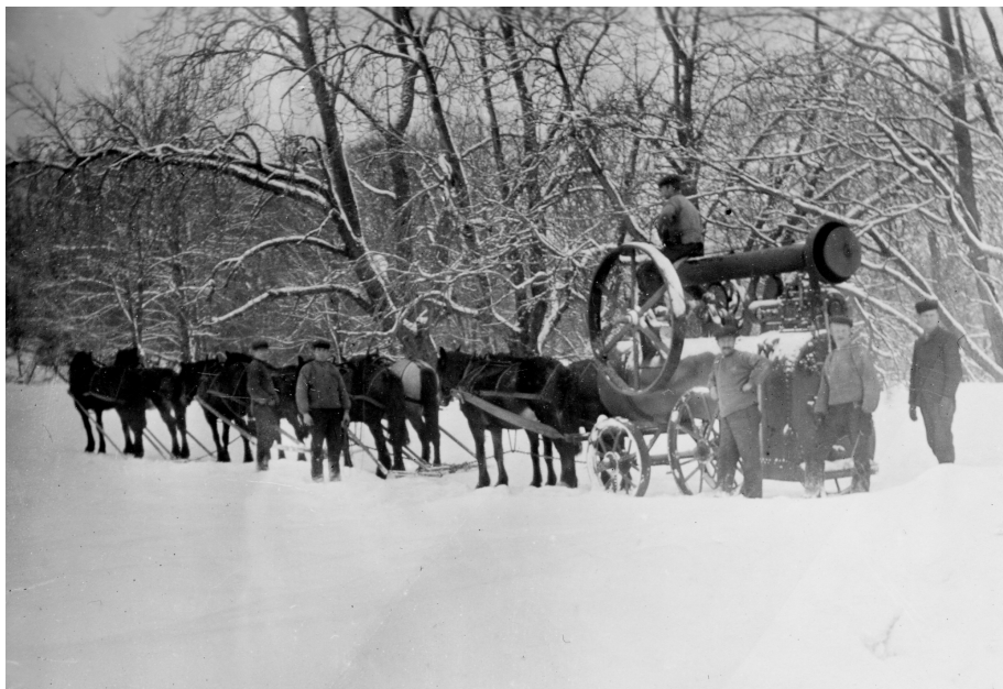
Lokomobilen, drivkraft for treskeverk og sag, under transport. Vinteren 1909–10. Trukket av 8 hester. I starten var lokomobilen eid av noen andre (Bøvolden?) og ble fraktet rundt på gårdene for bruk, blant annet som motor for trøskeverkene.
